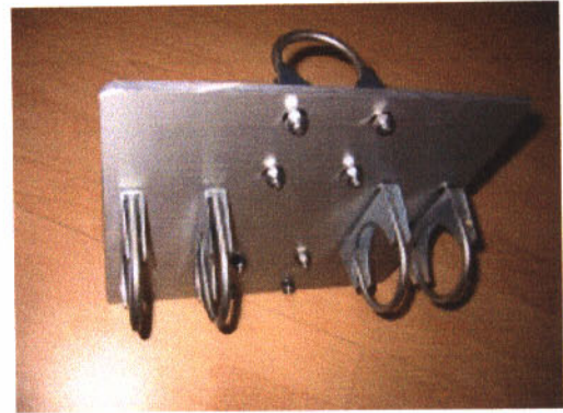
Boom-Masthalterung für große Modelle / boom to mast mounting for big models
