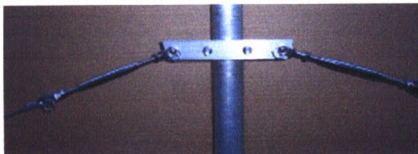
Zentrale Seilabspannung für Modelle über 6 Meter Boomlänge / centre boom truss for models over 6 meter boom length
